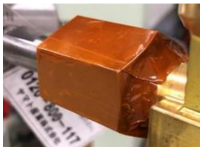
图 C.3 氢气检测胶带粘贴要求
